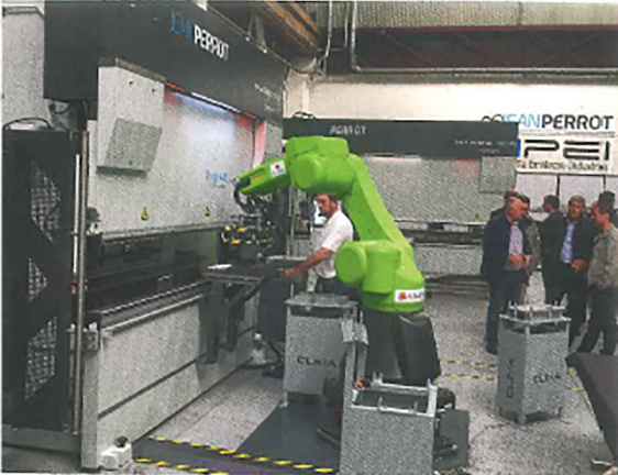
Autre variante de fonctionnement de la cellule : l'opérateur se trouve, sans danger, au plus près du robot qui lui amène les tôles à plier pendant qu'il réalise le pliage.
