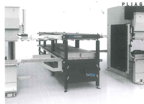
Le magasin manuel d'outils de pliage peut alimenter deux presses plieuses
