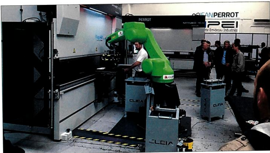
Cette cellule de pliage qui associe une presse plieuse et un robot collaboratif peut fonctionner en mode manuel, assistée ou automatique. Source : www.machine-outil.com
