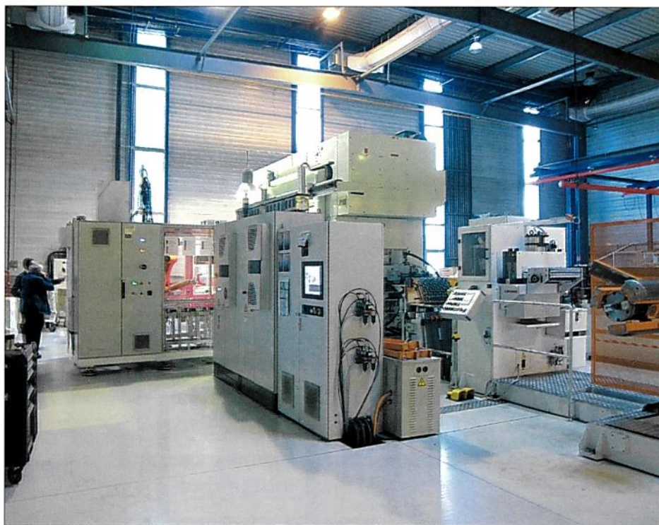
Des îlots robotisés truffés de capteurs et organisés autour de presses japonaises Aida à quatre bielles extrêmement précises, produisent dans le département écomobilité de nouvelles gammes de stators et rotors pour véhicules hybrides et électriques. Source : MS
