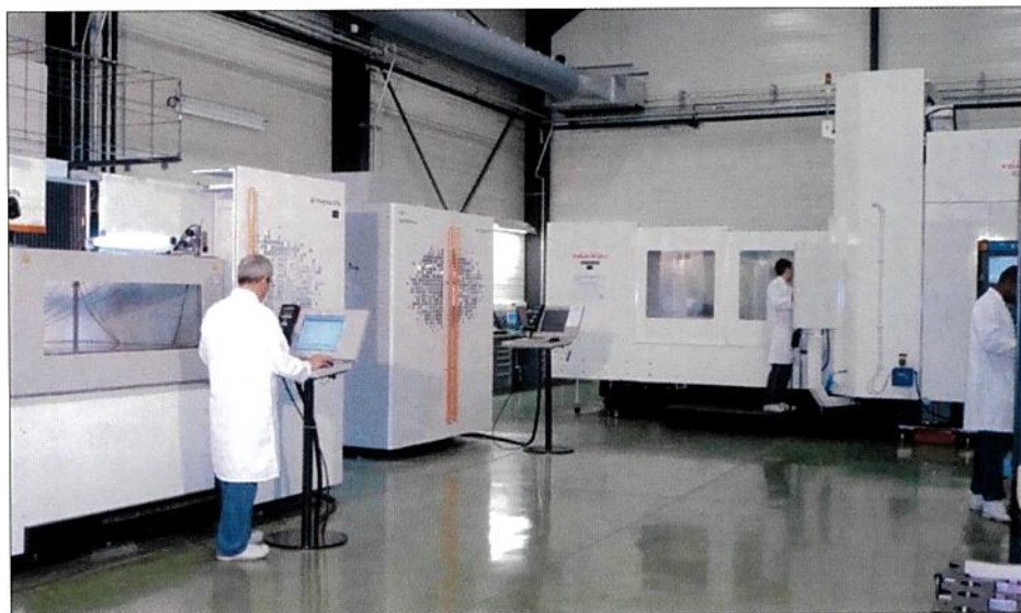
La fabrication des outils, dont la précision est de l'ordre de +/- 2 ou 3 µm, est assurée par des équipements ultraperformants, comme le centre d'usinage Yasda YBM 121 8Y unique en Europe. Source : R.Bourgeois
