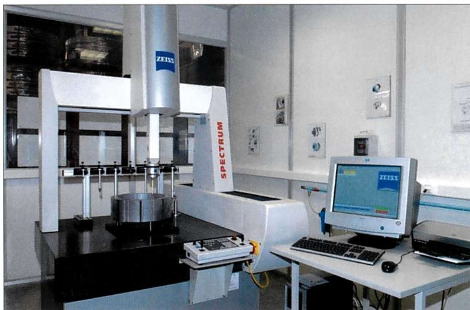
Des moyens de contrôle impitoyables, machines à mesurer tridimensionnelles et optiques Zeiss ainsi que des bras de mesure portatifs Romer, scrutent les moindres défauts. Source : R.Bourgeois
