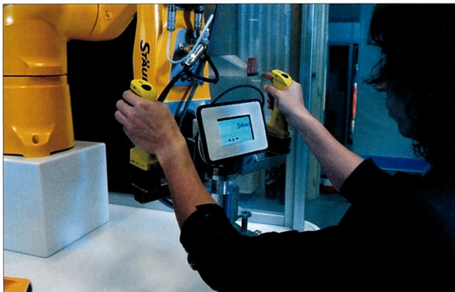
Stäubli dispose d'une gamme de six robots collaboratifs (TX2 CS9) en version standard, déclinables en version spécialisée (ESD, salle blanche, Stericlean, Environnement humide). Source : Stäubli
