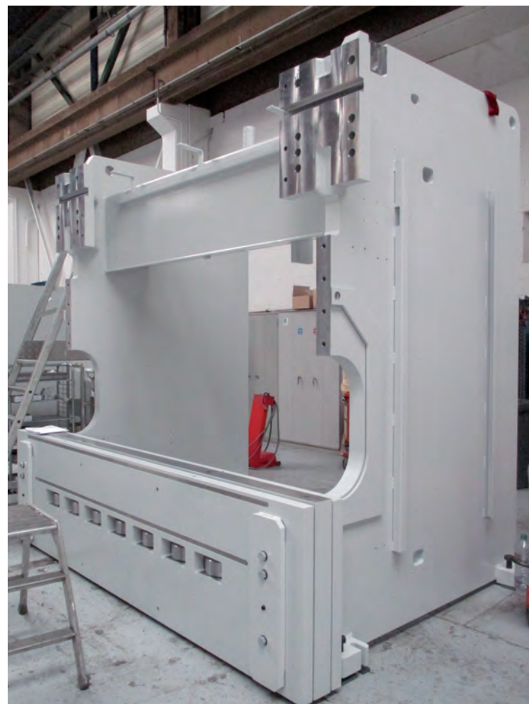
Bâti de presse-plieuse Manéo usiné et peint dans l'usine de Châlons-sur-Saône.
