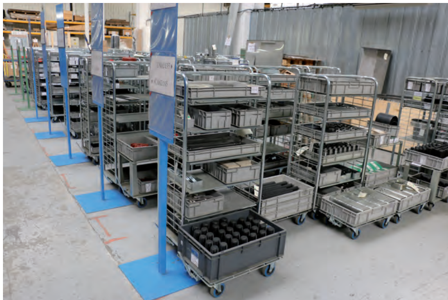
Aire de préparation des éléments en vue de leur montage sur les machines. Pour chaque opération, le monteur trouve tout ce dont il a besoin, prêt à l'emploi sur un chariot.
